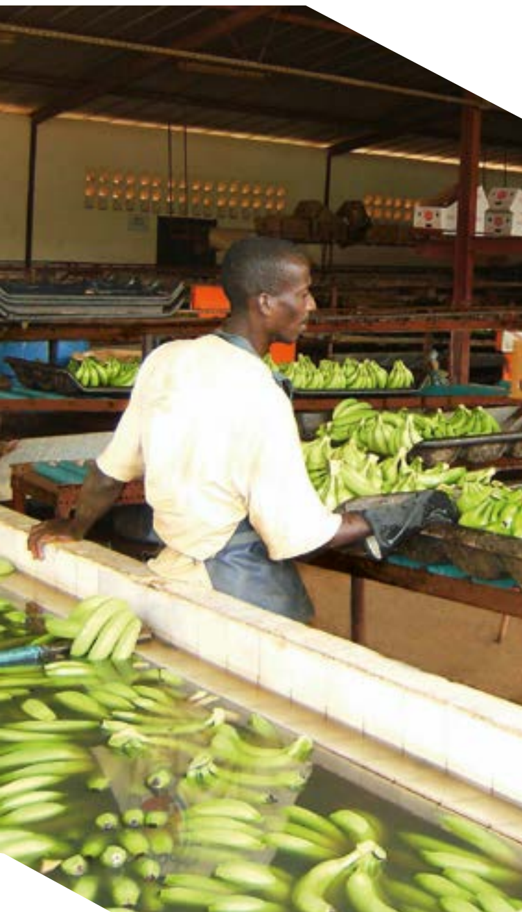
La personne chargée de la sélection des fruits, prélève les bouquets dans le bac de rinçage, pour les positionner sur des plateaux de séchage, selon une classification de taille et longueur, pour être ensuite convoyés vers la zone d'emballage...
